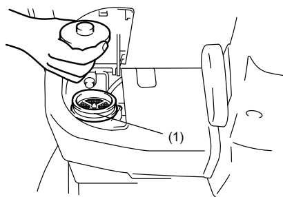
(1) Tanque de reserva
