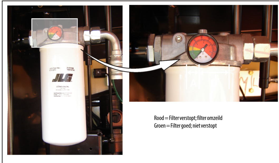
Figuur 7-7. Conditie-indicator hydrauliekolie-retourfilter
